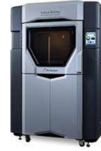
Makine: Stratasys Fortus 450mc Üretim Hacmi: 406x355x406mm
