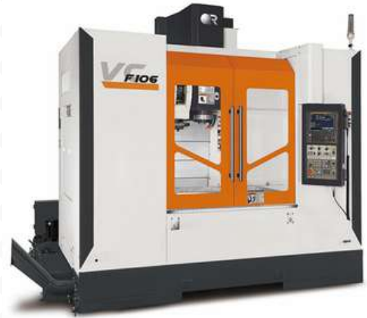
Makine: 3 eksen CNC İşleme Hacmi: 1060x600x560mm
